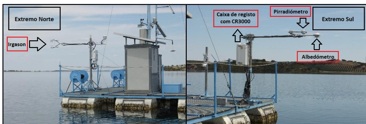
Figura 14 – Disposição do sistema Irgason, pirradiómetro, albedómetro e CR3000 na plataforma
