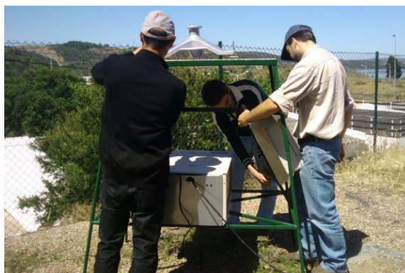
Figura 29 – Montagem da base, caixa de alimentação e caixa de registo
