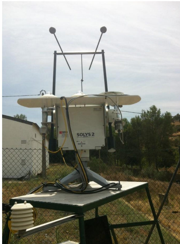
Figura 31 – Tracker e sensores após montagem
